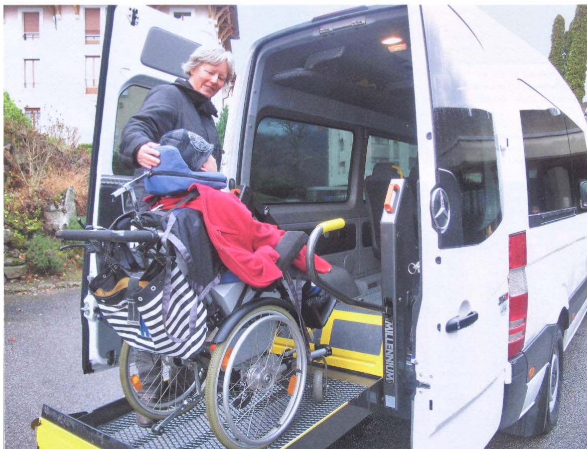
Bernadette Visinand apprécie le confort d'utilisation de la plate-forme élévatrice du nouveau bus de «La Parenthèse». (Photo: Patrick Monay)
